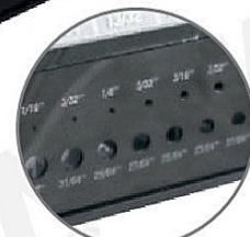
Medidor de brocas
