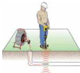
Encuentre sondas (transmisores remotos).
