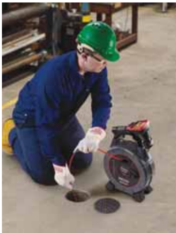
SeeSnake microDrain con micro CA-350 utilizado como monitor y dispositivo de grabación.
